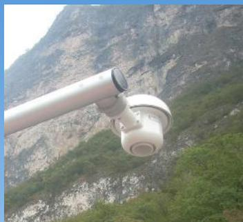
*Sensore ventilato di temperatura e umidità*
