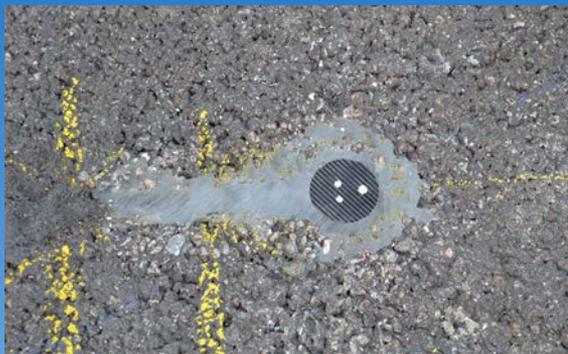
*Sensore di temperatura e salinità stradali*
